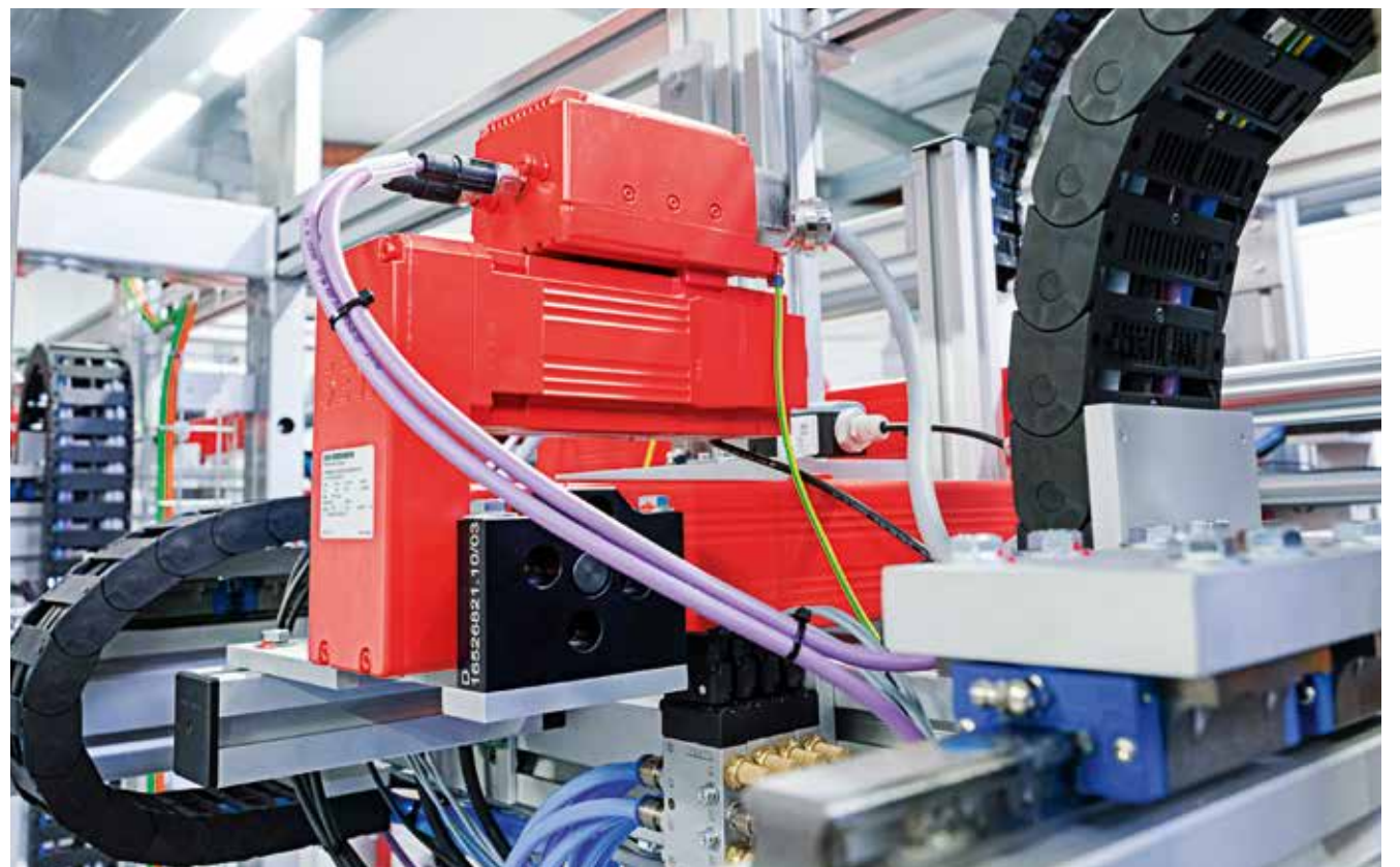
Die Messerverstellung im Volumen-Reduzierer Vario 558 der Firma Opitz Maschinenteknik GmbH erfolgt mit den Kleinspannungsantrieben ELVCD und Elektrozyklern CMS.. sowie einem schlanken Kabelschlepp für den Energie- und Kommunikationsbus.
